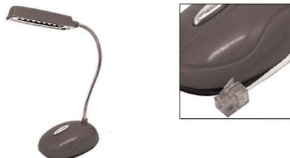
يجهل الكثير من الناس وجود استطاعة كهربائية عبر خط الهاتف الارضي، رغم شحها وانخفاضها ولكنها كفيلة بتقديم بعض الطاقة المناسبة، حيث يوفر خط الهاتف الارضي تياراً مستمراً يصل حتى 65.5 V حتى وإن كانت الخطوط مقطوعة من المقسم ولا يوجد فيها حرارة تبقى هذه الشحنة الكهربائية مستمرة.
